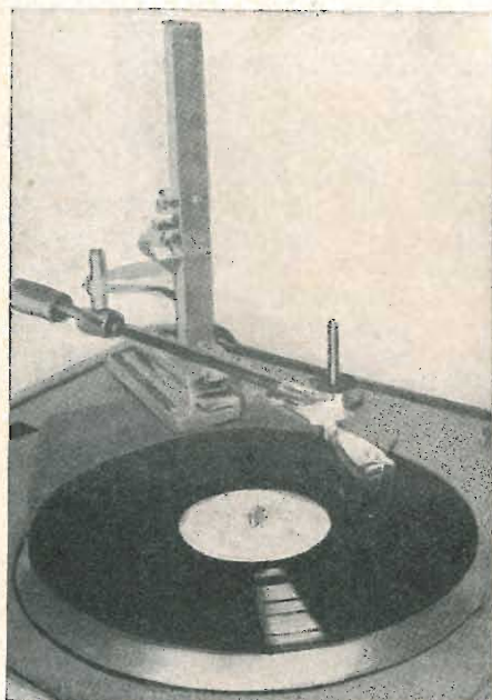
Fig. 6 - Braccio regolabile per la misura dell'inclinazione di modulazione e dell'angolo di adattamento verticale della testina di rivelazione.
